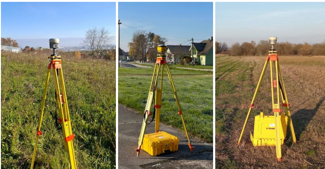
Slika 5.2 Uređaji R12i (lijevo), R780 (u sredini) i R980 (desno) na pripadnim lokacijama na terenu (foto: Tomislav Debeljak, Matija Matijević i Petar Jelić).
