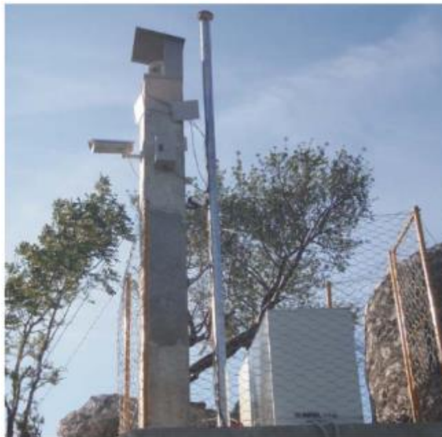
Slika 2.13. Glavna jedinica geodetskog nadzora (Arbanas i dr. 2011)
