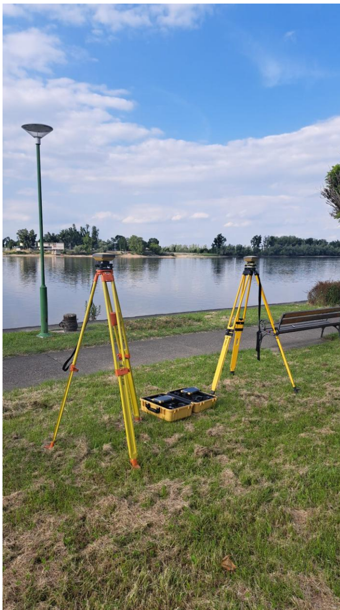
Slika 4.16 Topcon Hiper SR uređaji u Iloku
