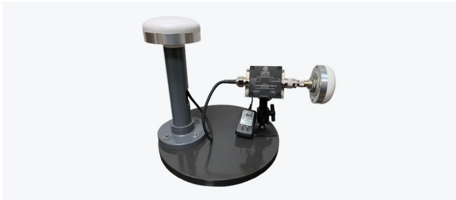
Slika 2.7 GNSS repeater (URL 10)
