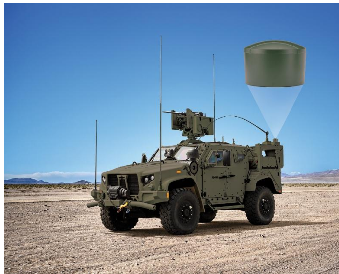
Slika 2.8 Primjer GAJT anti-jam antene (URL 12)
