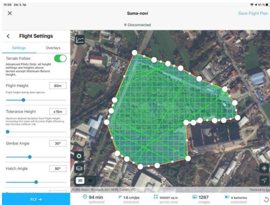
Slika 5.2 2D prikaz putanje leta (desno), parametri leta (lijevo) i podaci o letu (dno sučelja)
