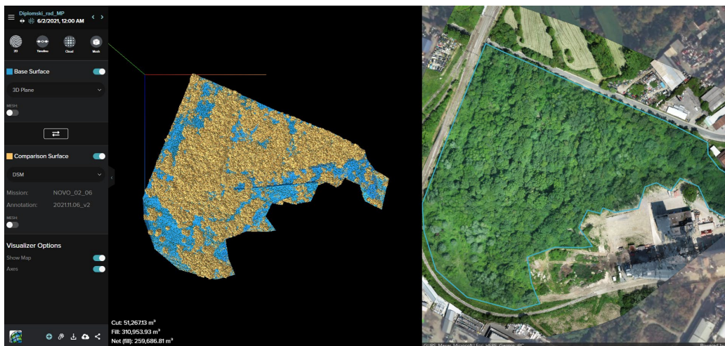
Slika 7.11 Izračun volumena šume u Site Scan-u i 3D prikaz volumena
