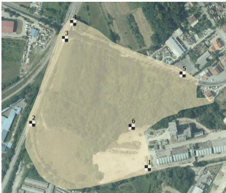
Slika 6.9 Položaj GCP točaka unutar područja snimanja za snimanje 30.4.2021.
