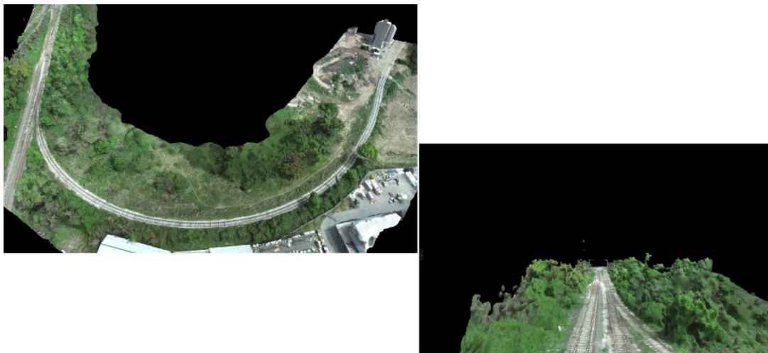
Slika 7.5 Prikaz 3D mesha pruge dobiven u Site Scan-u (lijevo) i uvećani prikaz trase (desno)
