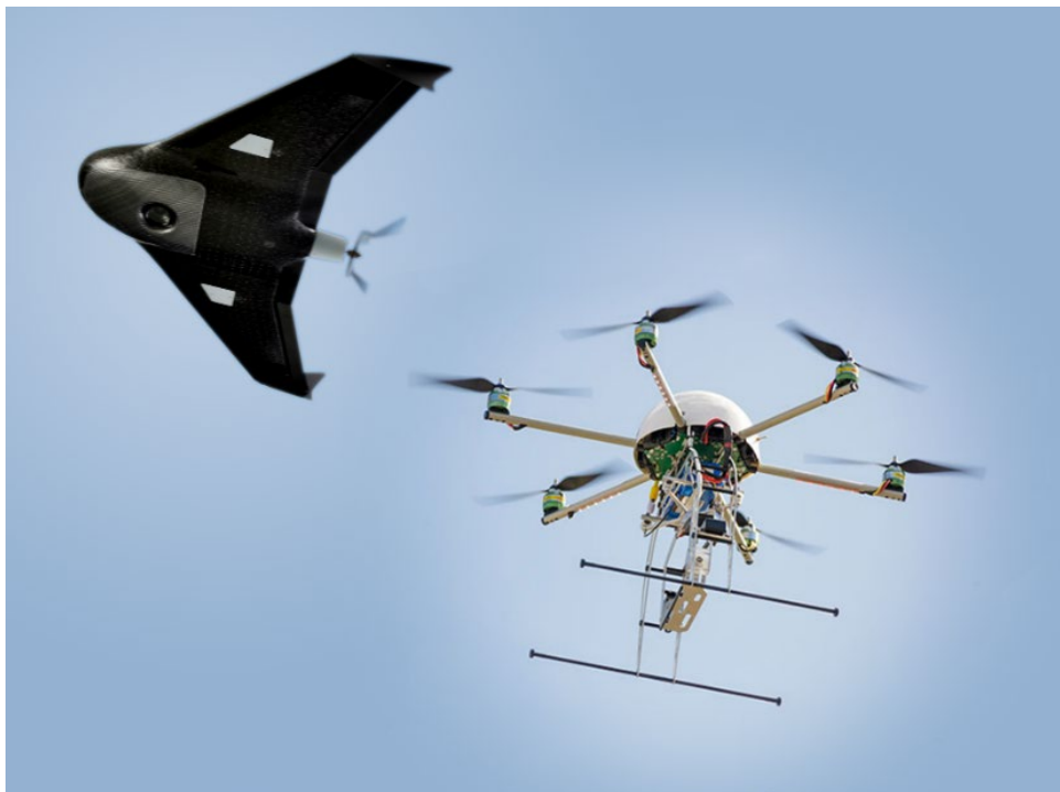
Slika 2.2 Dron s fiksnim krilima (lijevo) i multirotorski dron (desno) (URL 5)
