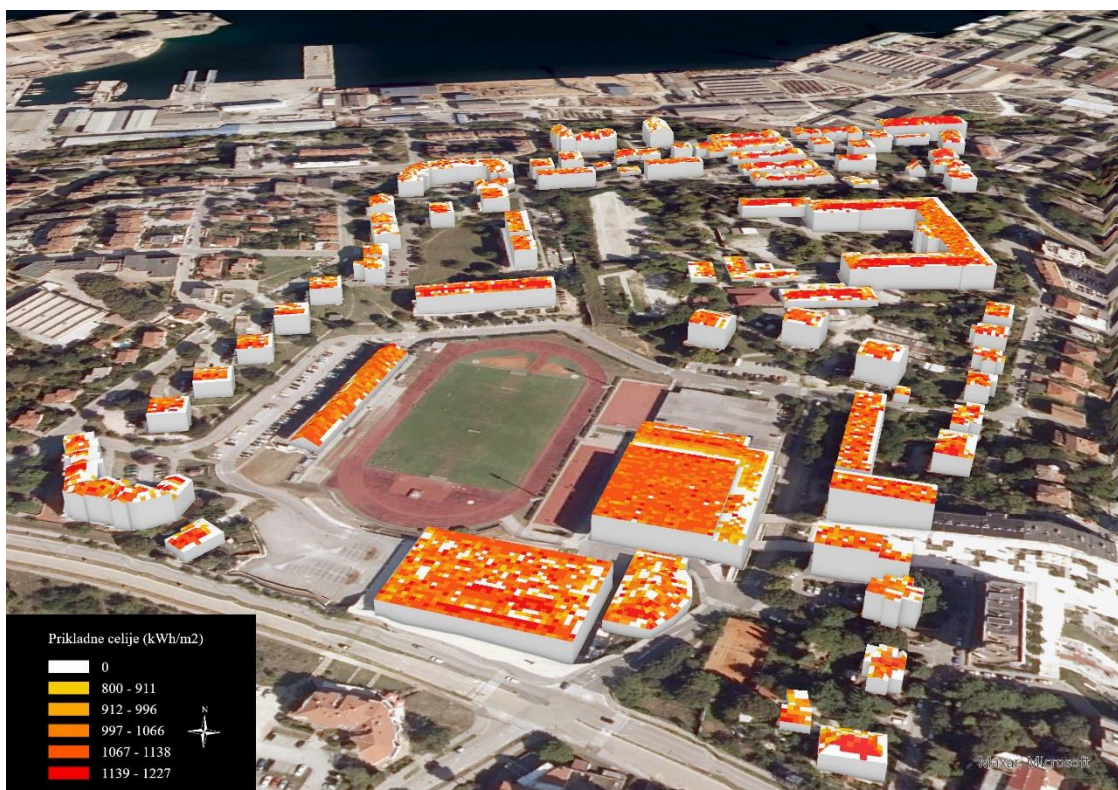
Slika 7.7. Površine krovova prikladne za ugradnju solarnih panela- prikaz s južne strane
