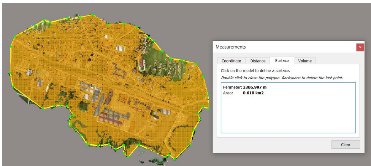
Slika 114. Funkcija mjerenja površine u CCM Viewer-u
