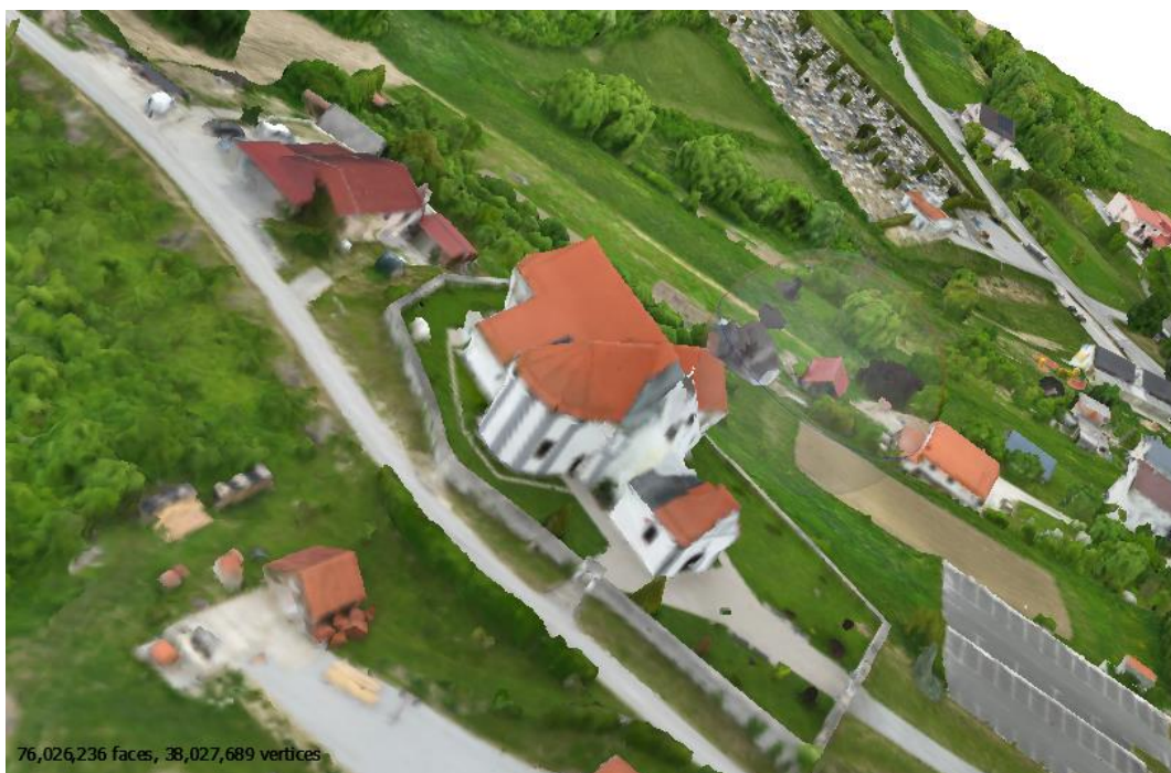
Slika 6.14 Rezultat izrade teksturiranog 3D modela u programu Agisoft Metashape
