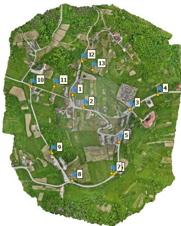
Slika 6.7 Položaj i numeracija kontrolnih točaka (GCP) u projektu unutar programa Agisoft Metashape
