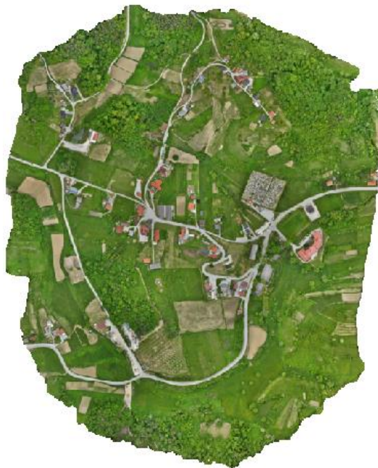
Slika 6.17 Rezultat izrade ortomozaika u programu Agisoft Metashape
