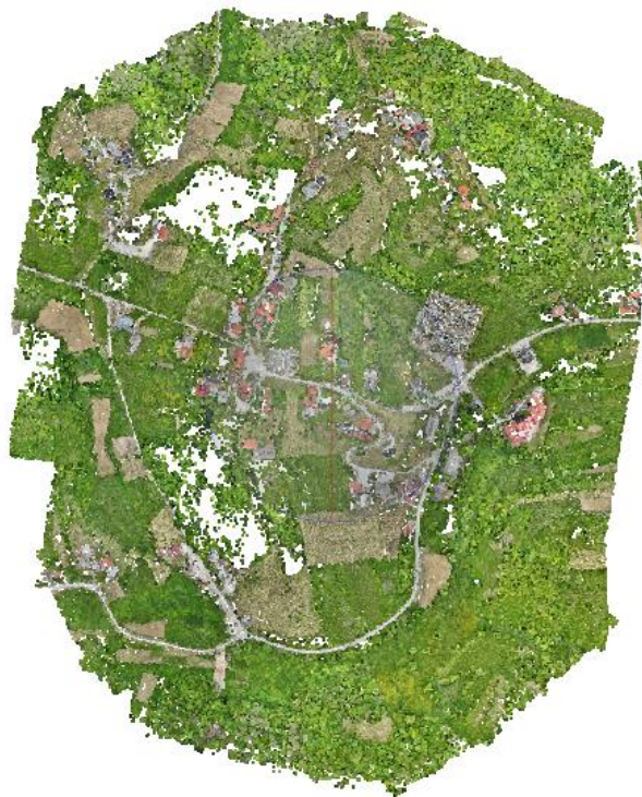
Slika 6.5 Oblak točaka male gustoće nakon poravnanja
