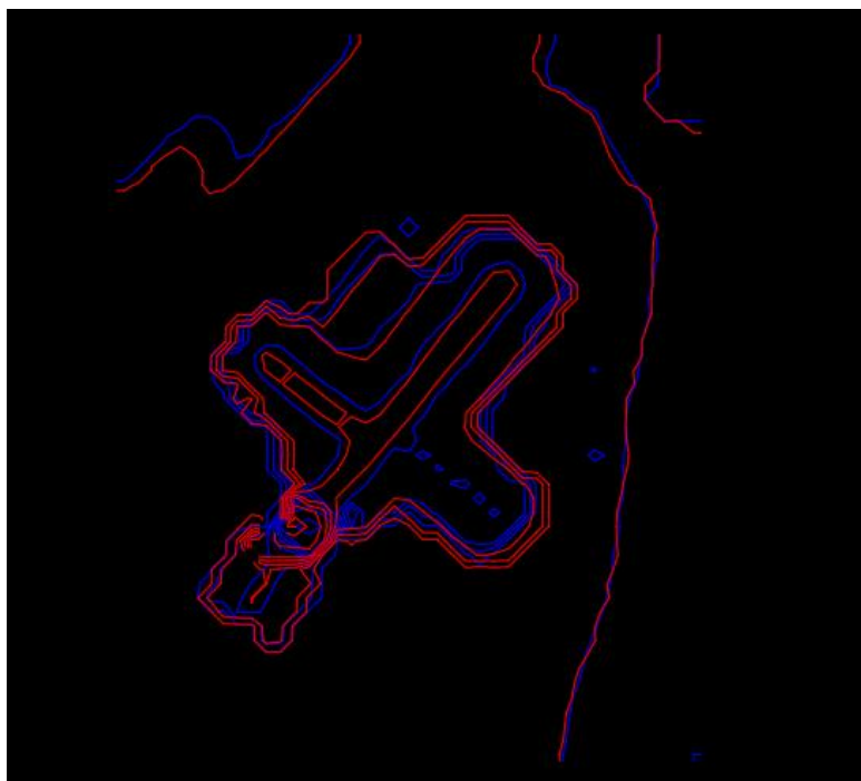
Slika 7.6 Konture LiDAR i UAV podataka u tlocrtu
