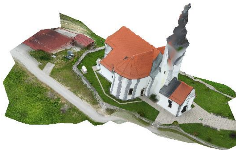
Slika 6.20 Kombinirani model – LiDAR geometrija s UAV teksturama
