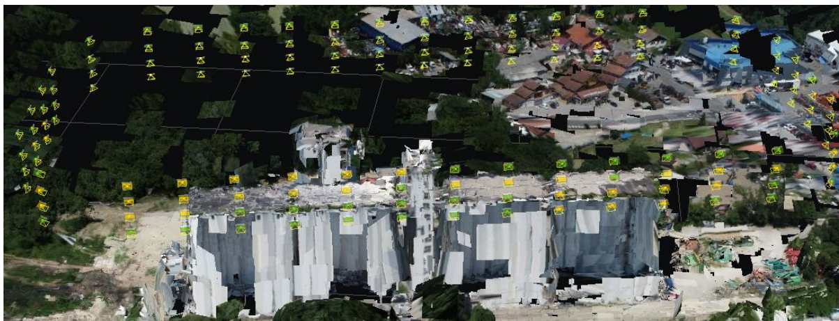
Slika 6.8 Rezultati provedene aerotriangulacije – naglasak na silos
