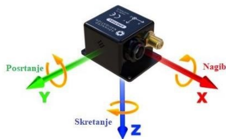
Slika 5. Uređaj Spatial INS/GNSS s prikazom koordinatnih osi
