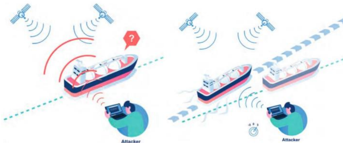
Slika 2. Jamming (lijevo) i spoofing (desno) GNSS signala
