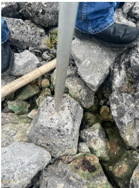
Slika 3.2.1 T146 – primjer uništenog trigonometra
