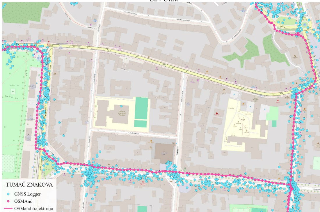
Slika 18. Sirovi GNSS zapisi i map-matching trajektorija (S24 Ultra) – Kačićeva, Ilica i Prilaz Gjure Deželića
