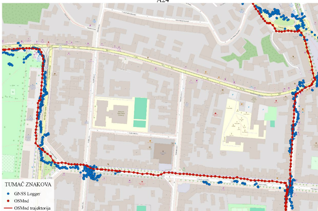
Slika 19. Sirovi GNSS zapisi i map-matching trajektorija (A24) – Kačićeva, Ilica i Prilaz Gjure Deželića
