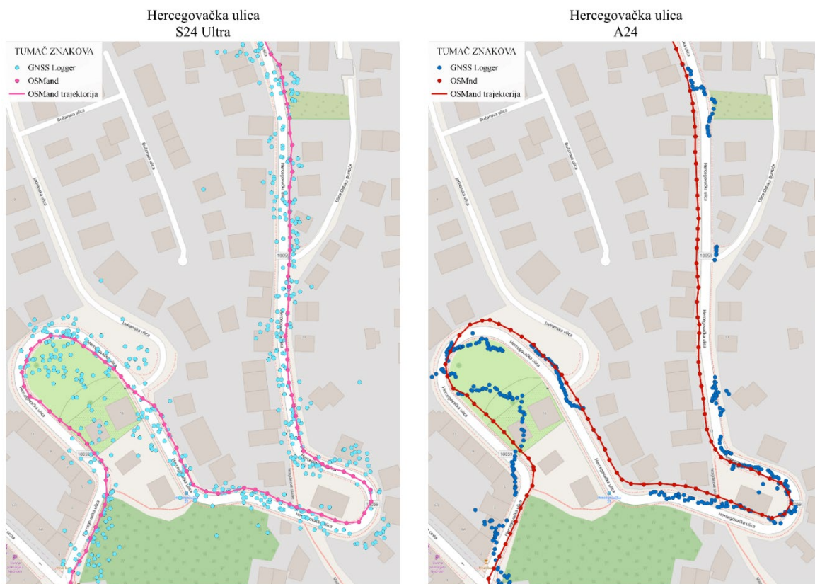
Slika 21. Sirovi GNSS zapisi i map-matching trajektorija – Samsung Galaxy S24 Ultra (lijevo) i Samsung Galaxy A24 (desno), dionica Hercegovačke ulice
