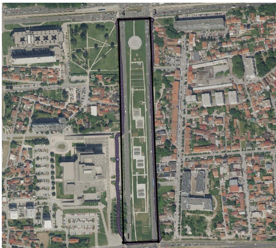
Slika 8. Prikaz idealne trajektorije (crni poligon) i podataka mjerenja (hodanje - ljubičaste točke)
