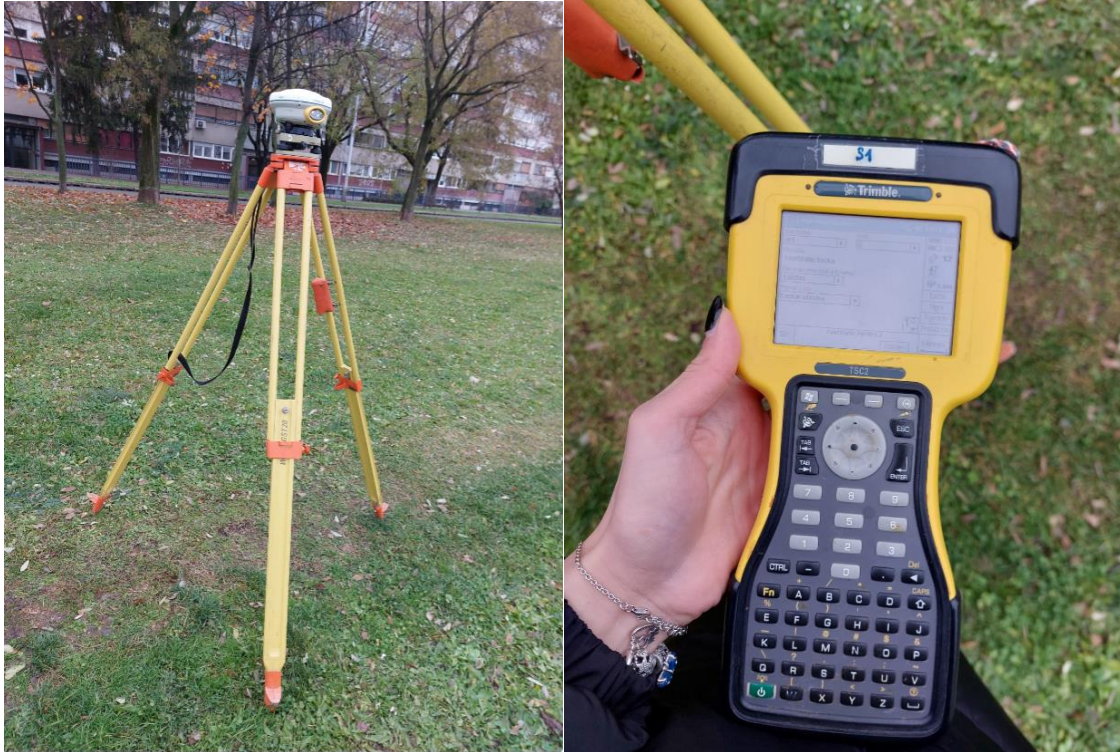
Slika 3. Trimble R8 GNSS prijemnik s kontrolerom TSC2
